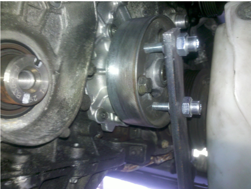
Blocage de la poulie pour faciliter le serrage/desserrage
